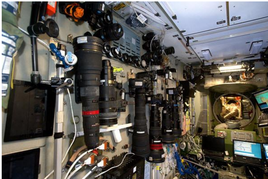
Nikon D4s et objectifs utilisés à bord de la station spatiale internationale – © ESA/NASA
