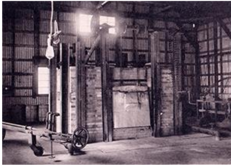
Four de fusion de 500 kg pour la fabrication des optiques Nikon - Photo Nikon Corp.
